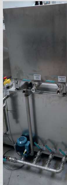
Olieseparator SEPP P2 integreret.
