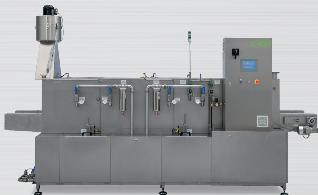
Compo Cleener 1040 vask - skyl - tørring med 63 Amp. rustfrit styreskab.
