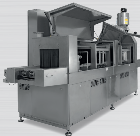
Compo Cleener 1040 med 80 Amp. rustfrit styreskab med damp-kondensator.
